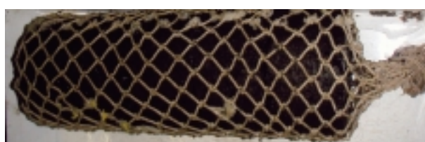
写真 - 3 凍結融解後供試体状況
