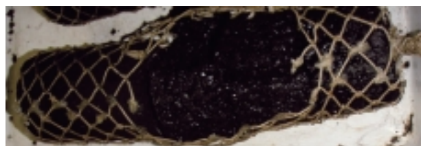
写真 - 3 凍結融解後供試体状況
