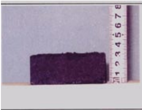
写真－3 造粒化した石炭灰の凍上試験結果
