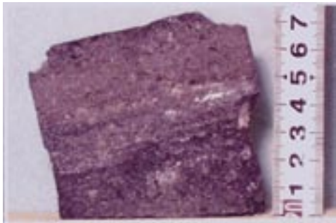
写真－4 造粒化した PS 灰の凍上試験結果
