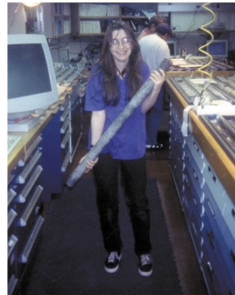
採取したコアは直径65mm程度の柱状 ©ODP
