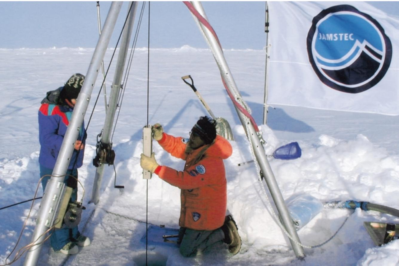
氷上に三脚をたて、J-CADの水中ケーブルに水温・電気伝導度計を取り付ける
