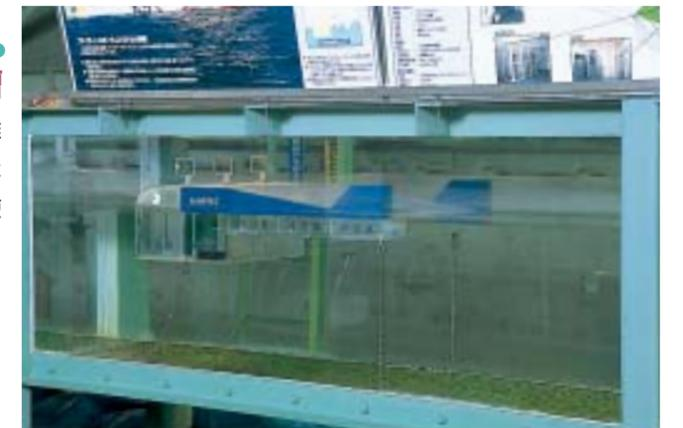
水槽内にあるのは波力発電装置「マイティーホエール」。模型を使って海流と波の実験をする
