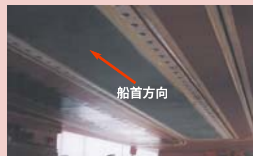
深海調査研究船「かいいい」の船底に装備された送波器アレー
