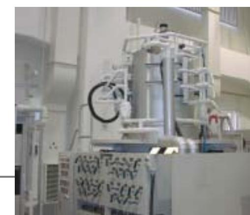
希釀された微生物はこの「分離装置」に移送されます。ここで微生物の栄養源となる培地と混合され、うまく増殖されているかをチェックします。わざわざ視認することなく、集中監視室にあるレーザーを使った増殖モニターで計測することができます。
