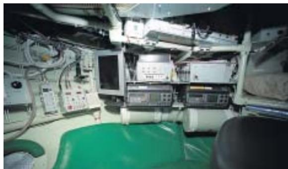
パイロットののぞき窓の様子。マニピュレータ操作スイッチやカメラモニターがある
