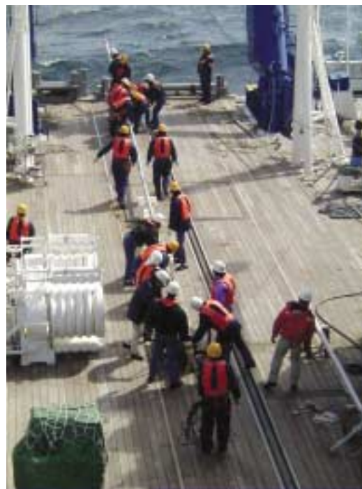
最大20mの堆積物を採取できるピストンコアラ
