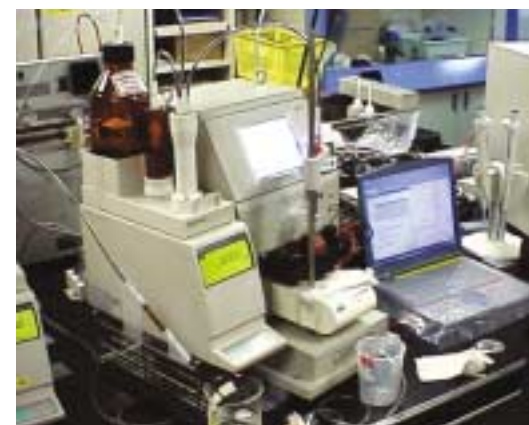
時間短縮を図り、効率のよい分析を行うために作られた溶存酸素測定装置
