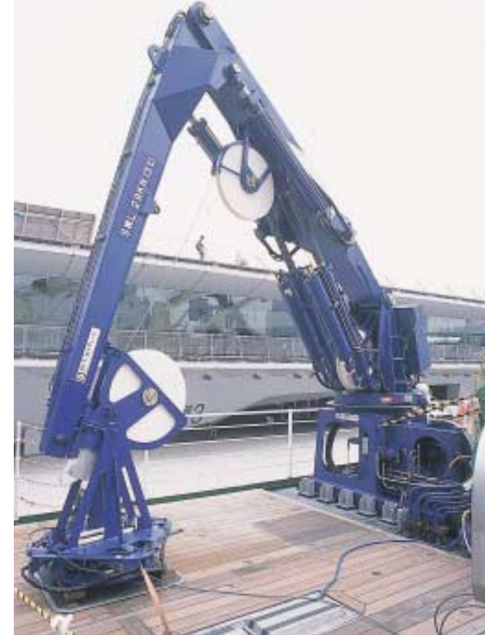
CTD計測及び採水に使用される高性能クレーン・ウインチシステム。今回の観測研究で海水試料を迅速に処理できるよう、設置位置が変更された
