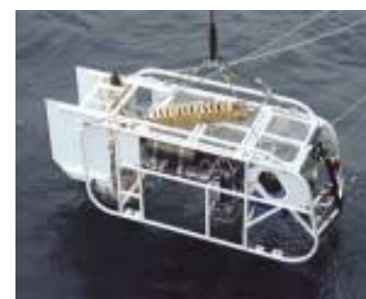
「ディープ・トウ」 母船からケーブルで曳かれた曳航体。水深4,000~6,000mまで潜航可能。カメラで海底をリアルタイム観測する
