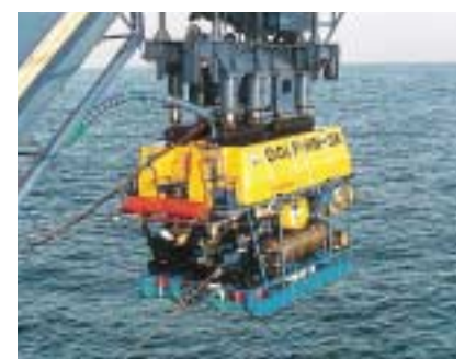
「ドルフィン-3K」 母船から光・電気複合ケーブルで電力と通信を供給し、推進器とマニピュレータも持つ。最高3,300mまで潜航可能で、TVカメラを搭載
