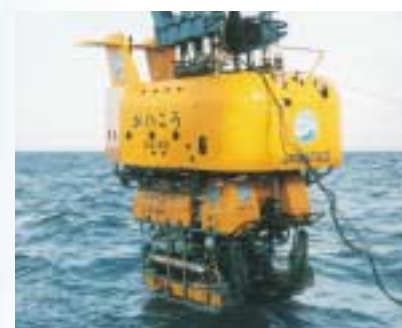
「かいこう」 最高11,000mまで潜航可能。ランチャーにはサイドスキャンソーナー、ビークルにはTVカメラとマニピュレータを搭載
