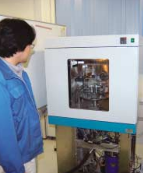
有孔虫の微化石を同位体分析装置にかけている様子
