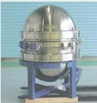
「うらしま」に搭載されているチタン合金製耐圧容器に収まった燃料電池
