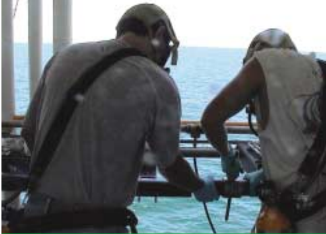
掘削コアから有毒な硫化水素が発生するためマスクをして作業をする
