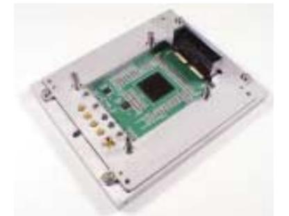
中央の黒い部分が2cm×2cmのCPU(プロセッサ)。これ1枚で8ギガフロップスの演算処理能力がある。
