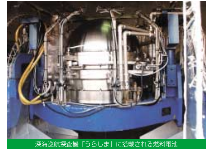
深海巡航探査機「うらしま」に搭載される燃料電池
