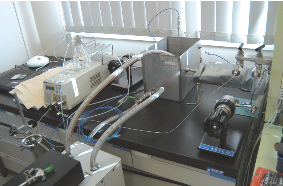
熱水噴出孔がタンパク質生成の化学反応場になったことを実験で再現するためにつくられた流通型反応装置。
