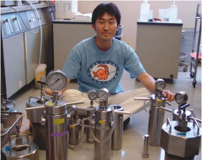
様々な微生物を高圧力下で培養するために、自ら実験装置も開発した。
