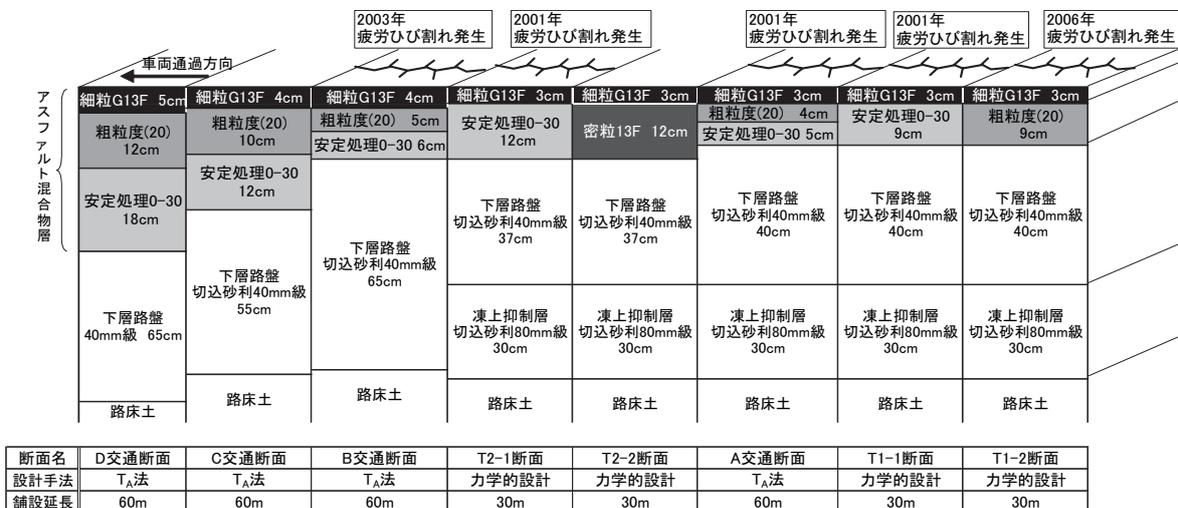
図-2 美々新試験道路の舗装断面および疲労ひび割れ発生状況
