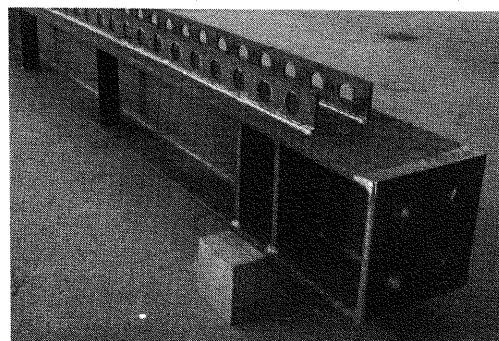
Photo 1 H 形鋼に溶接した PBL (PBL welded on H-section steel)
