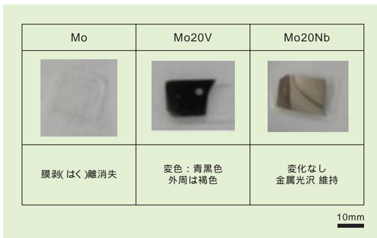
図2 耐湿テスト後の膜変化(純水浸漬: 25日後)
