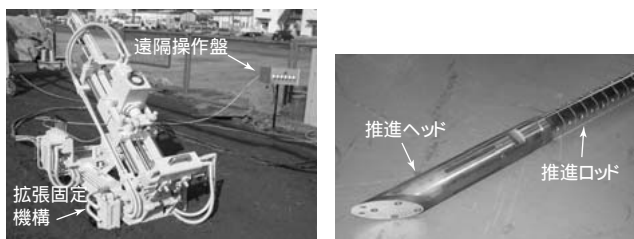
図3 推進機および推進ヘッドと推進ロッド
