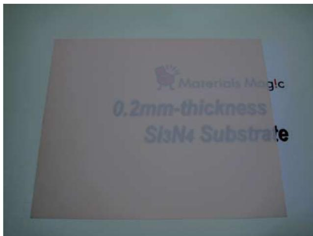
図2 厚さ0.2 mmの窒化珪素白基板
