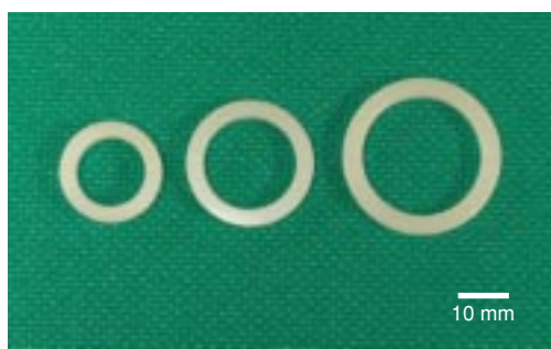
図1 カレントトランス用コア Fig. 1 Cores for current transformers
