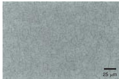
図2 1,050℃焼入れ、サブゼロ処理、500℃焼戻しを各2回施したASL<sup>®</sup>555のマイクロ組織
