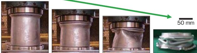
図 15 衝撃吸収部材モデルの圧潰過程の様子
