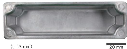
図2 舟型形状テスト品の外観
