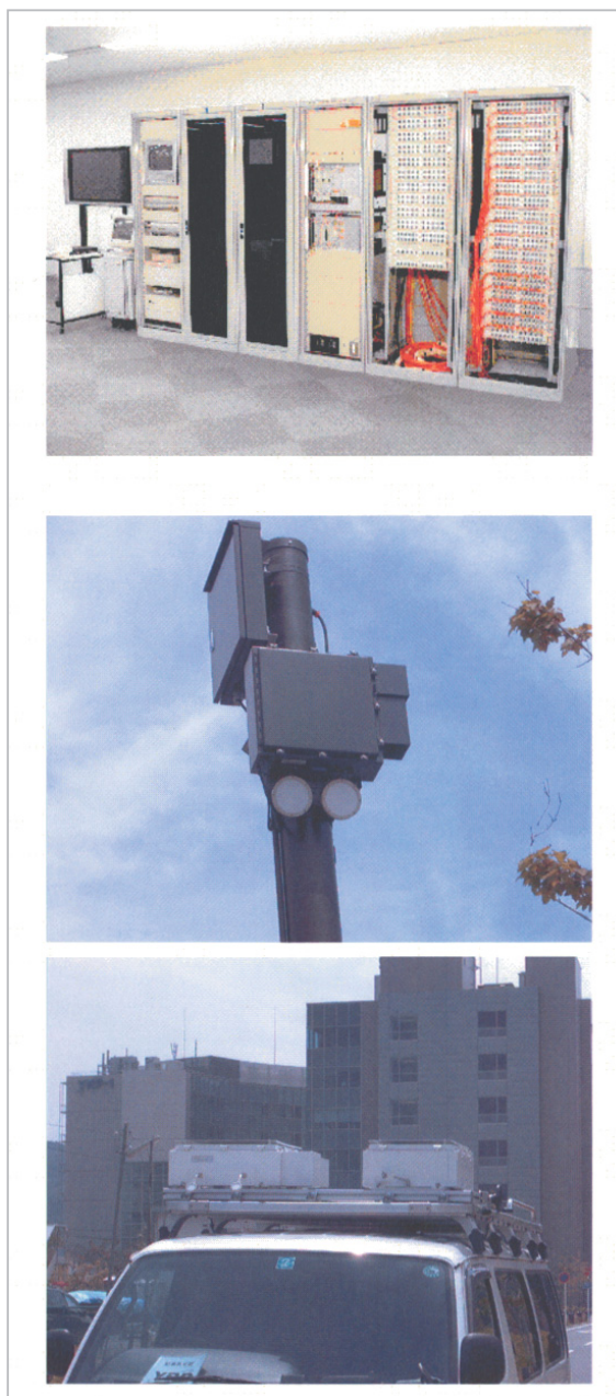
図4 統合基地局、局地基地局、移動局
