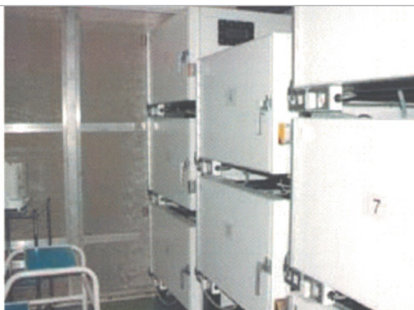
図6 長期実験用ラット脳局所曝露装置 共振長モノポールアンテナ 周波数1500 MHz
