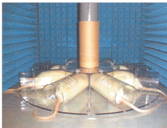
図5 ラット脳局所曝露装置 共振長モノポールアンテナ 周波数1500 MHz
