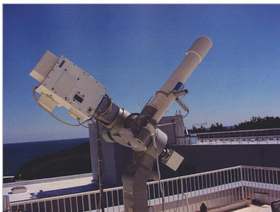
図4 高精細H $\alpha$ 太陽望遠鏡
