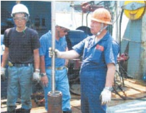
図4 実坑井試験中のソンドリトリリーブ作業 リグ上でソンドを掘管内に降下している様子
