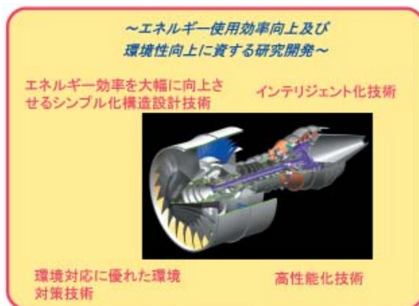
図3 環境適合型高性能小型航空機用エンジン
