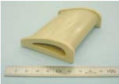
図2 窒化ケイ素製のタービン静翼モデル部材
