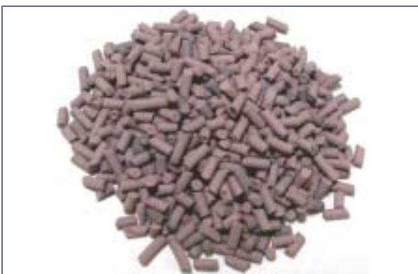
図1 開発触媒の写真
