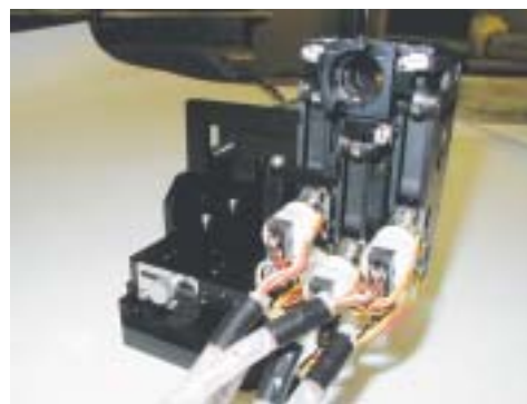
図1 実験で用いた自動制御ミラーホルダシステム
