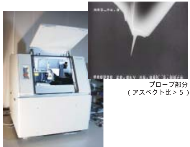
図4 レジストパターン計測用AFM装置(計測精度0.5nm以下)
