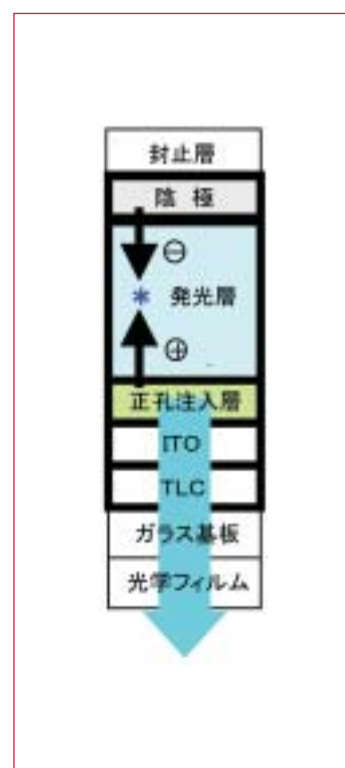
図4 高分子有機ELデバイス断面図
