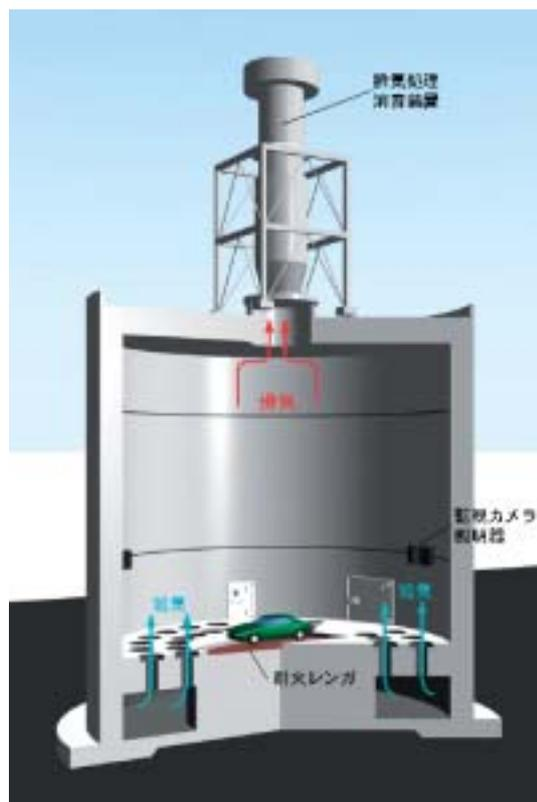
図2 防爆火災試験ドームの構造
