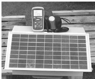
図16. 太陽光パネル電源装置
