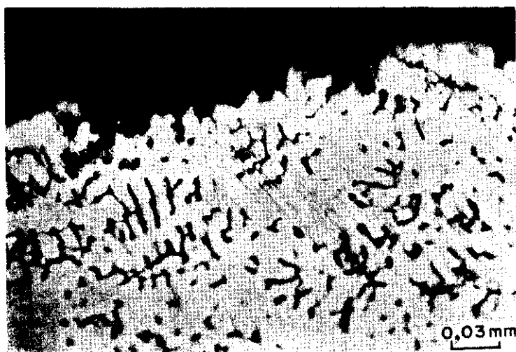
写真 1 D-308 溶着鋼のシルビー試片の破面
