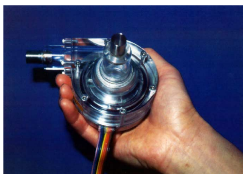
図 1 開発中のモノピボット遠心血液ポンプ
