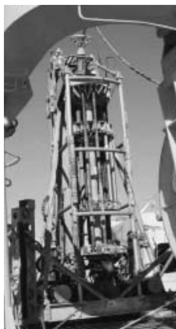
図 3 世界で唯一実地運用されている我が国の海底設置型掘削装置の概観。
