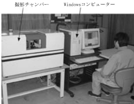
図 2 マイクロフォーカス型 X 線 CT 装置。撮影チャンバーの中に、試料をセットしてイメージングを行う。X 線の制御や画像再構成は隣接したパーソナルコンピューターで行う。
