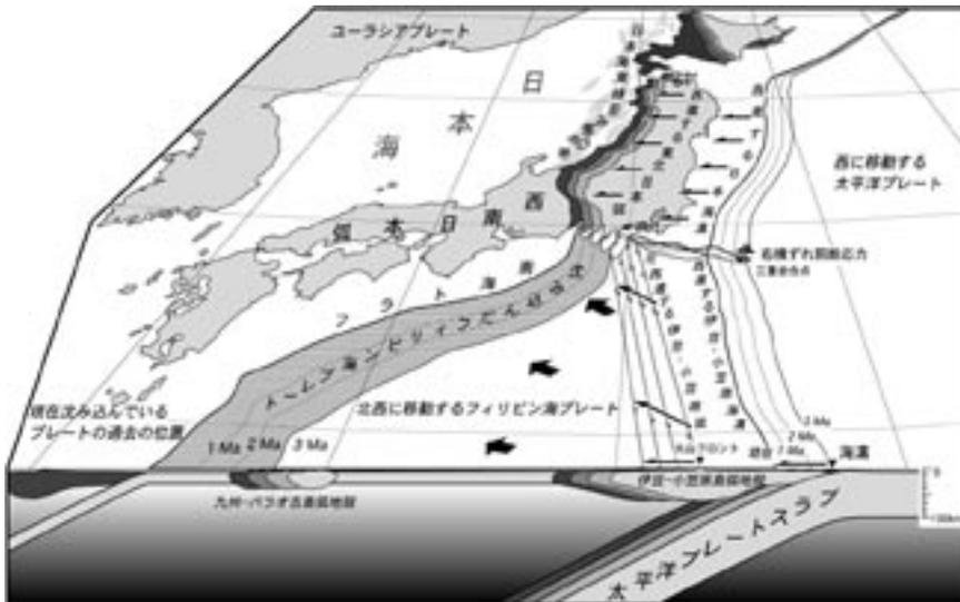
図 5 TTT 三重会合点に沈み込む太平洋プレートのスラブは剪断されない，すなわち日本海溝と伊豆-小笠原海溝が連続するとすると，東北日本は西に移動せざるを得ない．フィリピン海プレートの運動ベクトルの西向き成分で日本海溝が西に移動するが，その一部は日本海溝に沿う造構性浸食 (tectonic erosion) で消費され，残りの成分は東北日本を西に移動させ変形しやすい背弧を東西に短縮させる (高橋, 2004b)．
