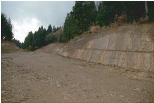
図3 東方からみた地点①のトレンチ全景。急斜する魚沼層とそれを覆う段丘堆積層。
