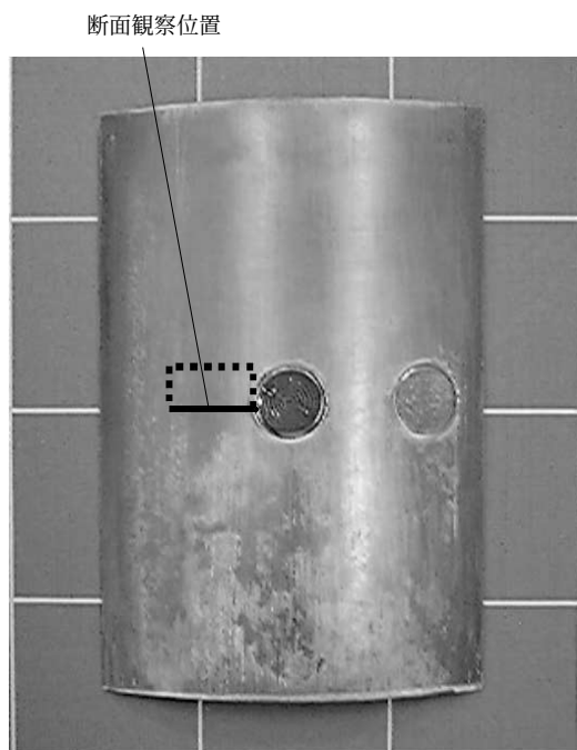
第 9 図 成形した CFRP 静翼モデルの外観（制御あり） Fig. 9 CFRP vane model (with control)
