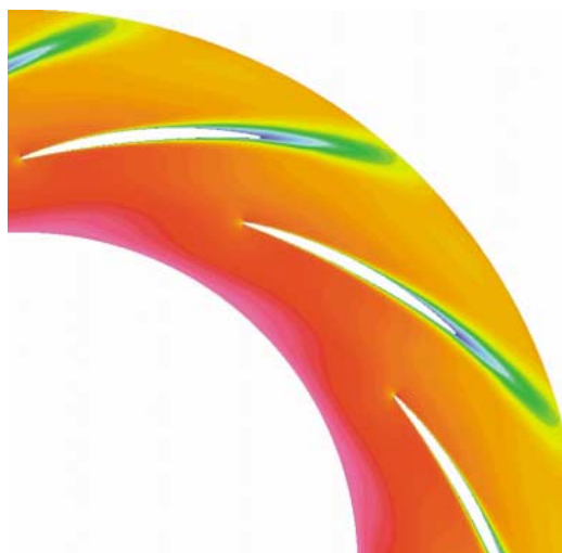
第8図 ディフューザのCFD解析 Fig. 8 CFD analysis of diffuser
