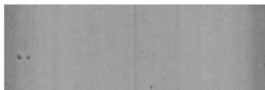
(c) スパッタによるシリコン中間膜を用いた試験片（800 回摩擦後）
