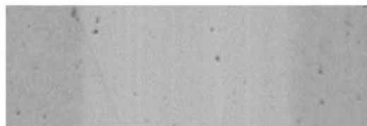
(b) プラズマ CVD にイオンミキシングを組み合わせて作製した C-Si 中間膜を用いた試験片（35 000 回摩擦後）
