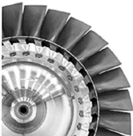
第 6 図 TPL-B 形過給機のタービン翼の外観
