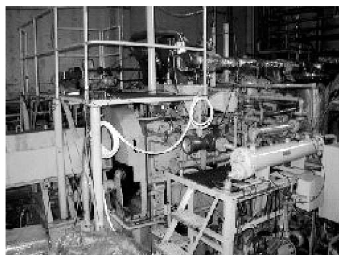
第5図 単気筒供試エンジンの外観 Fig. 5 Single cylinder test engine (1-26HX-AG)
