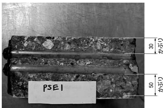
第 10 図 試験体割裂 (単位: mm) Fig. 10 Picture of splitting specimen (unit: mm)
