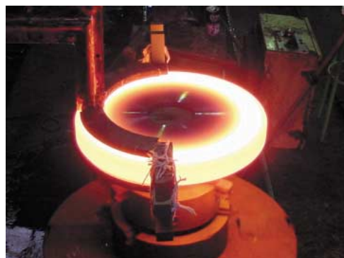
第 7 図 高周波誘導コイルによる部分的な熱処理 Fig. 7 Partial heat treatment with induction coil
