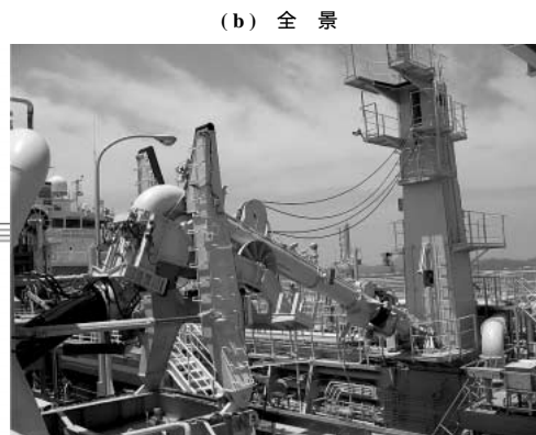
第10図 浚渫土砂船外排送管のかん合状況 Fig. 10 Coupling condition of over board discharge pipe
