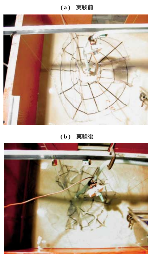
第 12 図 シートのしわの影響 Fig. 12 Effect of wrinkles in the sheet
