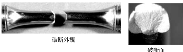
第 10 図 破断した LCF 試験片
