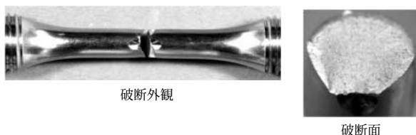
(b) Co を MSCoating で肉盛補修した試験片
