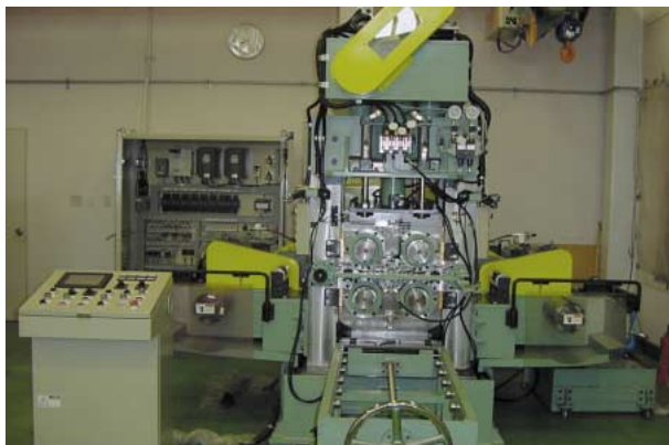
第 8 図 納入事例圧延機外観 ( 12 段 X ミル )
